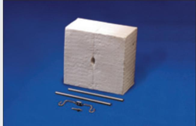
세라믹 섬유를 Edge-Grain과 한 덩어리(Monolithic) 형태로 제작한 세라믹 단열 블록으로 고밀도, 압축율, 자동 용접 Anchor 구조 등의 혁신으로, 재래식 모듈(Blanket로 접은 Fold & Stack) 보다 시공이 빠르고 성능이 뛰어나다. 또한 모듈의 시공 장치 및 구조 특성에 따라 코너 모듈 및 이형 모듈 등 다양한 형태로 생산이 가능하며, 모듈 내에 Anchoring 구조에 따라 모듈 종류를 구분하다.
